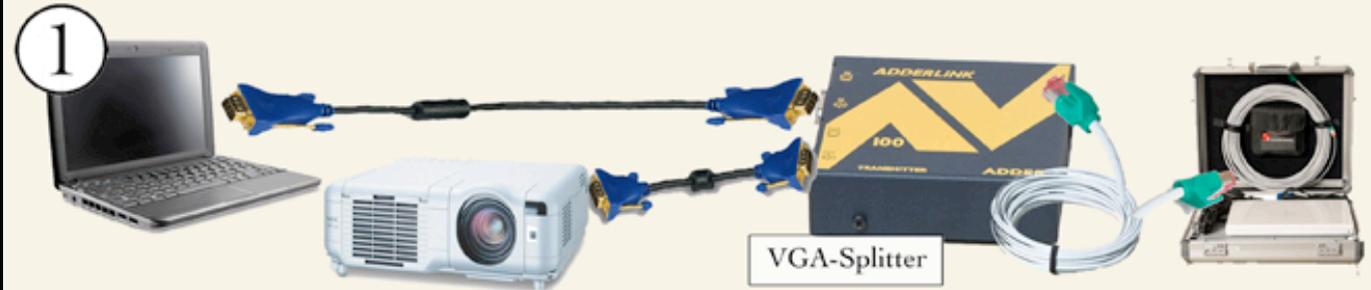
1 Präsentations-PC (ideale Auflösung 1024x768) mit dem Input (IN) des VGA-Splitters verbinden. Output des VGA-Splitters (OUT) mit Beamer verbinden. Netzwerkausgang des Splitters (PC-OUT) mit Netzwerkeingang (PC-IN) auf der linken Seite des Koffers verbinden.
