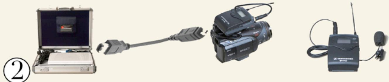
2 Camcorder mit dem Firewire-Eingang im Koffer verbinden. Funkstrecke einschalten. Sender und Empfänger auf die gleiche Frequenz einstellen. Batteriestand prüfen. Der Koffer, der Splitter und die Kamera müssen mit Strom versorgt sein!
